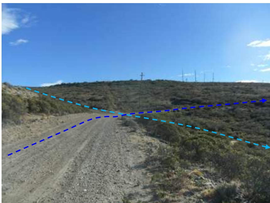
Foto IV.1-2. Se observa drenaje efímero (celeste) como interferencia de la traza (azul) de la línea de inyección a emplazar. Foto en dirección NE.
