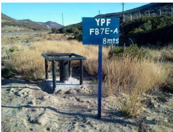
Foto IV.1-3. Freático FB7E-A ubicado aguas abajo de la pileta de emergencia.
