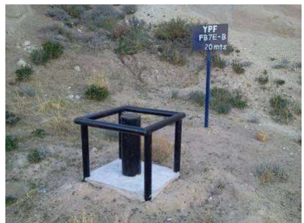
Foto IV.1-4. Freático FB7E-B situado aguas arriba de la instalación.
