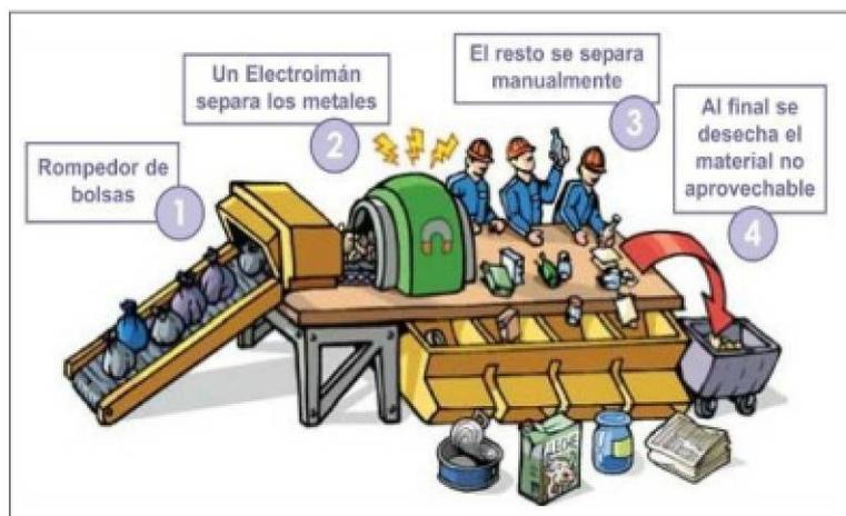
Imagen 9: esquema de cinta de separación de residuos
