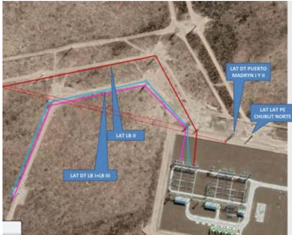
Figura AI- 13. Identificación de las LAAT en 132 kV que acometen a la ETPY.
