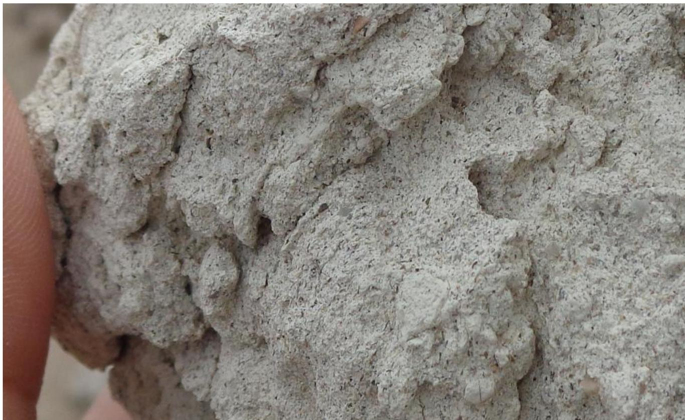
Fragmento de tobas de alta resistencia, obtenido de espesores intercalados entre los sedimentos granulares de unos de los frentes del sector "B"
