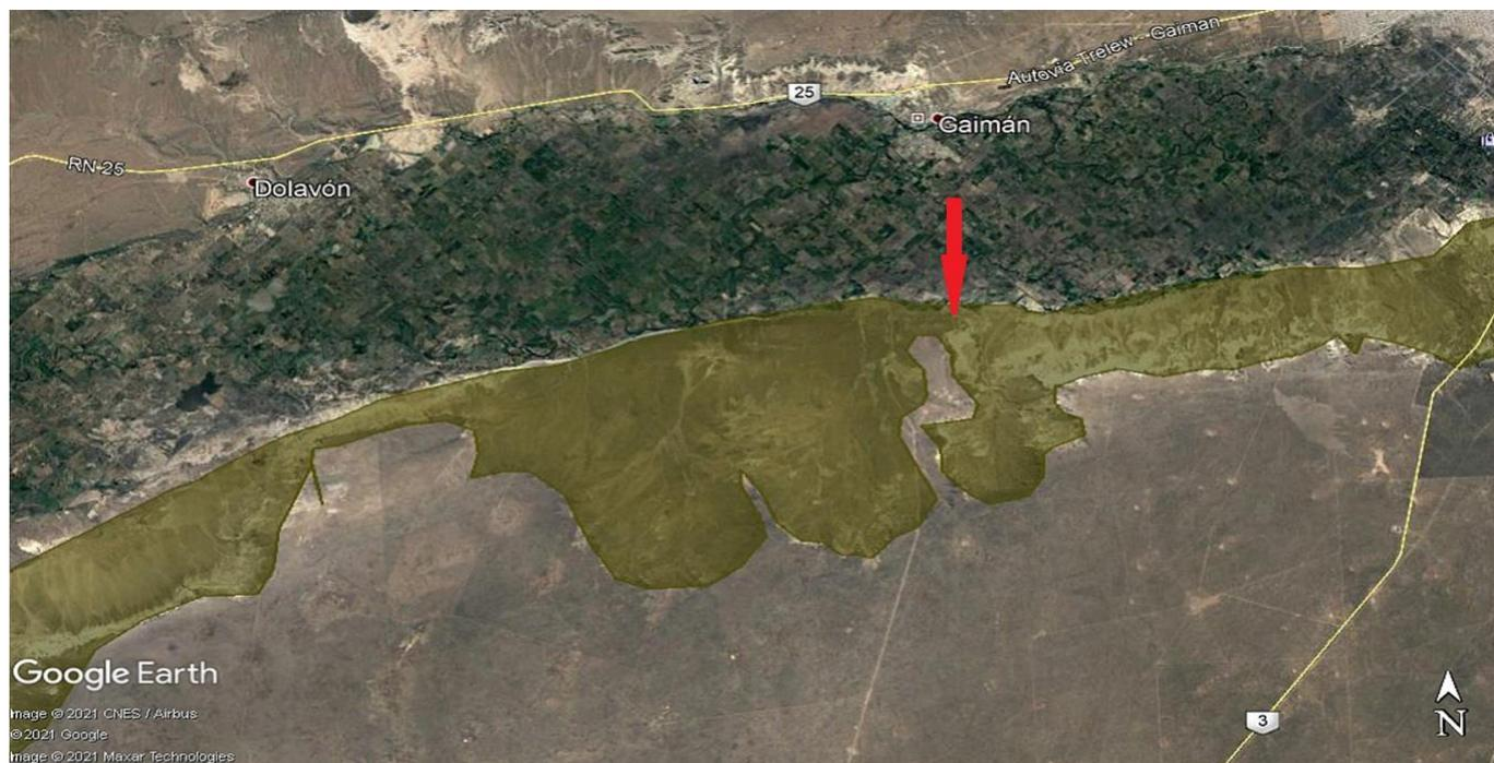
Imagen "H" El área coloreada de la imagen delimita aproximadamente el denso sistema de cañadones que se extiende al este y al oeste del sitio de la cantera, conduciendo las precipitaciones captadas en las terrazas y meseta superiores.
