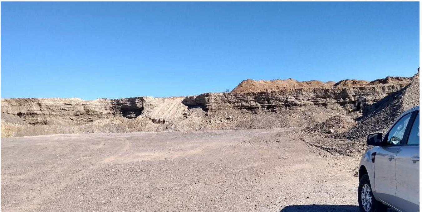
El frente de avance tiene alrededor de 4,5 metros de altura. El método de extracción es por desplome ya que el frente es de poca altura y lo permite. Se trabaja con una pala cargadora CAT de 3 m<sup>3</sup>, la que va excavando de abajo hacia arriba hasta lograr el colapso y desmoronamiento del frente, y procede a cargarlo y trasladarlo a la tolva de acopio acoplada a la zaranda o bien a la pila ubicada atrás de la tolva para acopiar y cargarla oportunamente.
