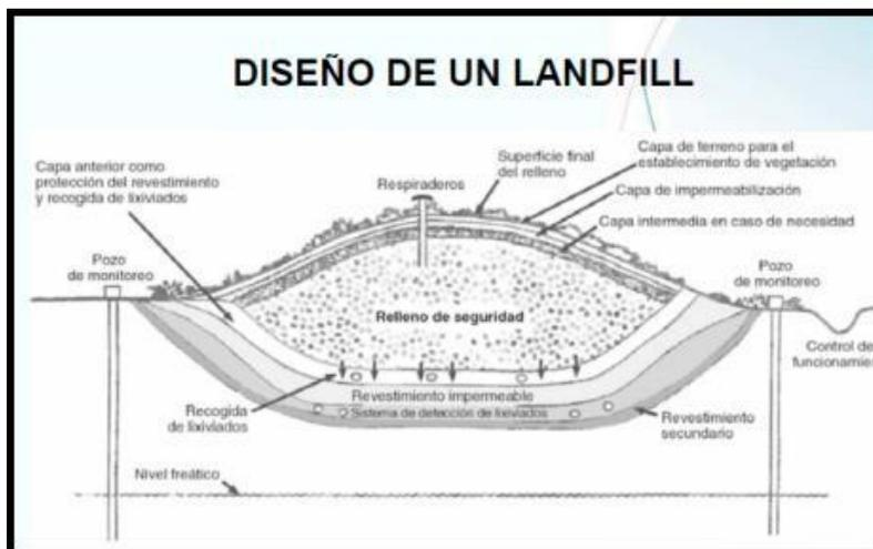
Fig. 10: Esquema de un Landfill
