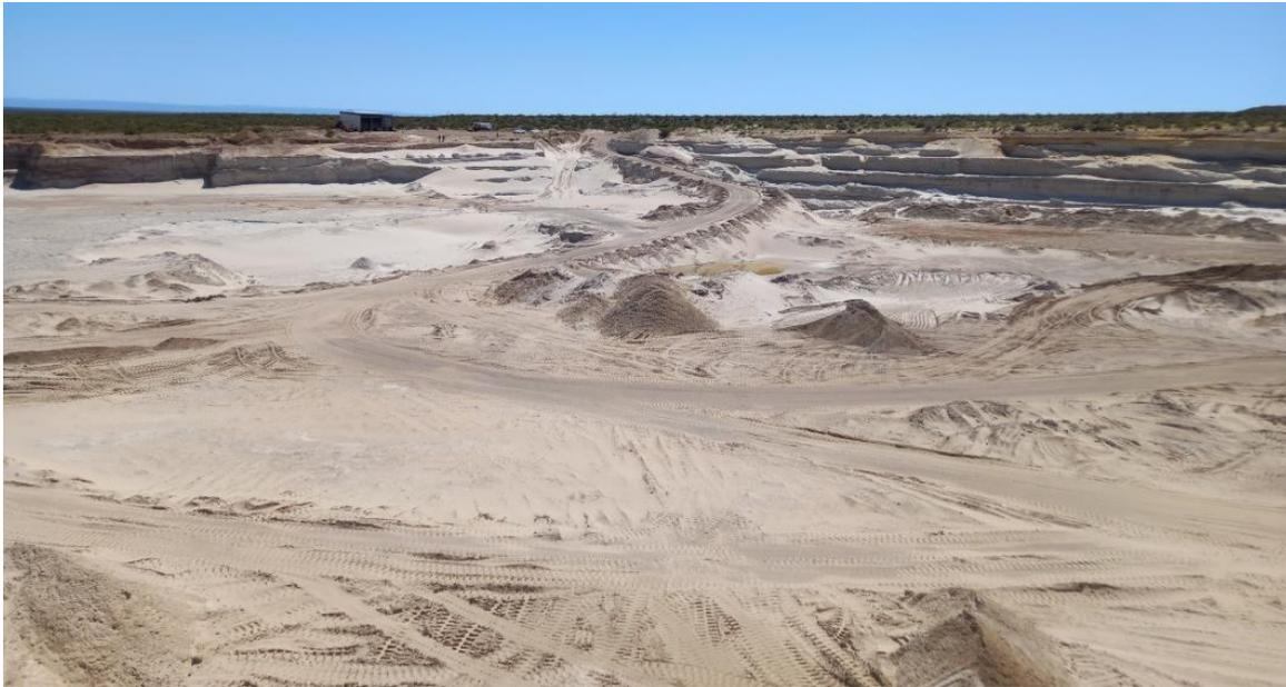
Vista panorámica de la cantera. Se aprecia el ingreso a la misma, los bancos y las diferentes alturas de taludes en los bordes.
