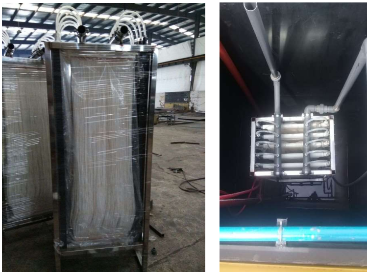
Figura N° 15: Membranas (imagen derecha) y cámara MBR con membranas ya instaladas (imagen izquierda).
