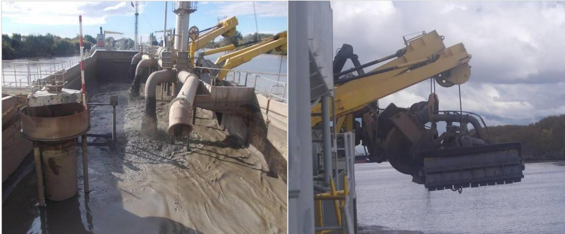
**Figura 42. Cántara (izquierda) y Cañería de succión (derecha).**
