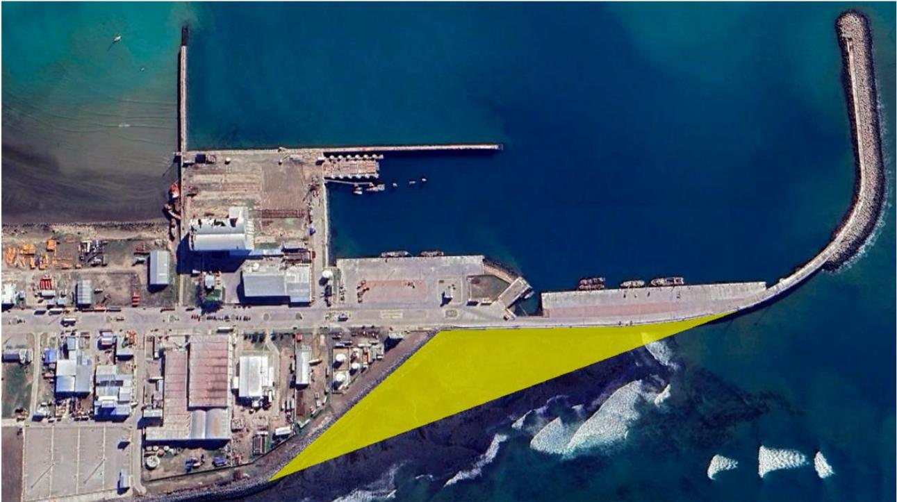
Figura 28. Planta de las obras para la alternativa de relleno de en el sector sur del puerto. Fuente: Serman & Asociados S.A., 2023a.
