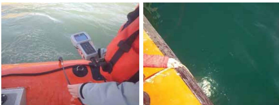
Figura 23. Registro de parámetros físico-químicos de agua de mar, utilizando sonda multiparámetro y disco de secchi.
