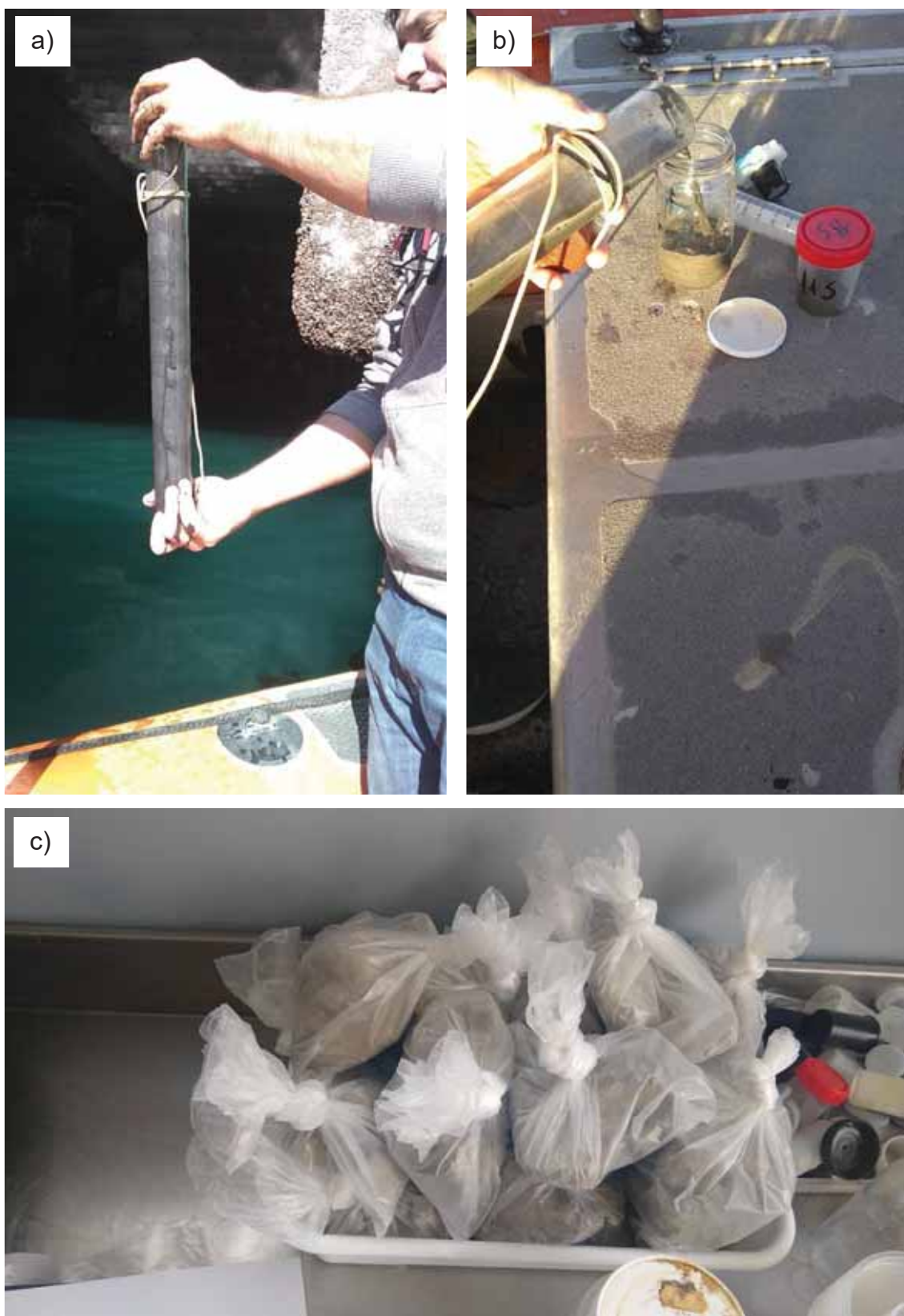
Figura 18. Metodología de muestreo. a) Procedimiento de homogeneización de la muestra en el muestreador Hope. b) Trasvase de sedimentos a los recipientes. c) Muestras secas de sedimentos para granulometría.
