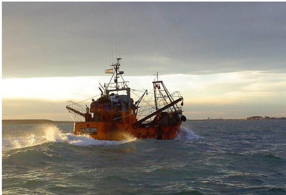
Figura 23. Buque de la flota costera / amarilla de puerto Rawson, se observan los tangones a ambas bandas. Imagen: Obs. Leo Jerez, Secretaría de Pesca de Chubut.
