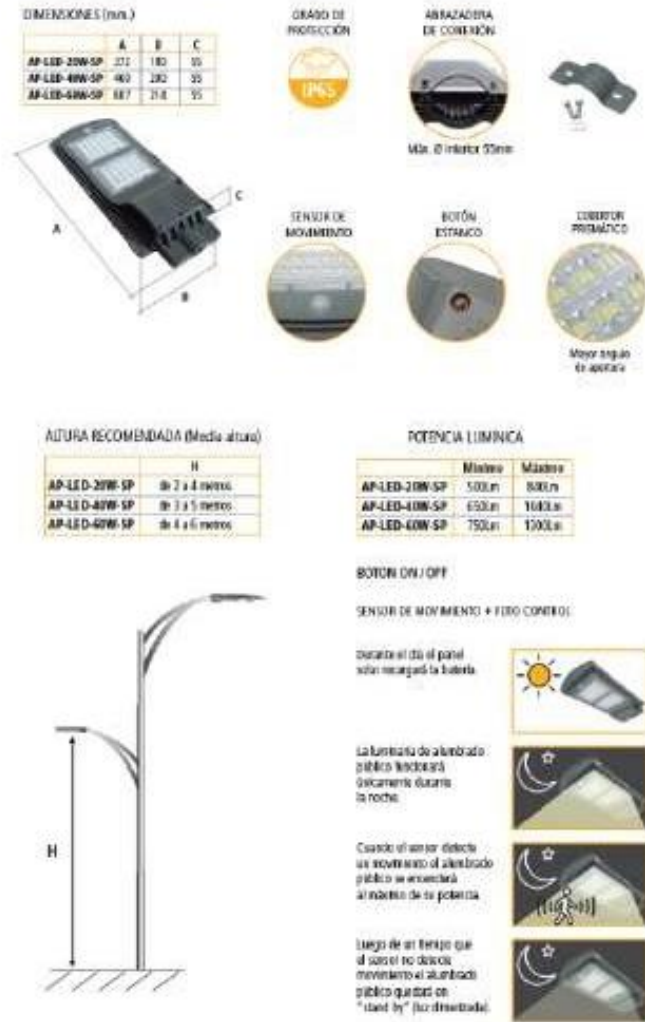
Figura 17. Características técnicas: Luminarias a led autónomas Fuente: La Providencia
