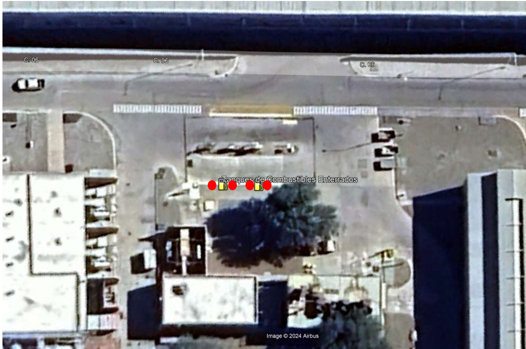
Figura N°41: Posible ubicación de los 4 puntos de muestreo de suelo sobre los tanques soterrados.
