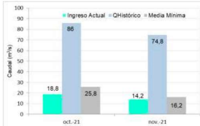
Figura N°39: Caudales de ingreso al Dique Ameghino en Octubre y Noviembre de 2021. Datos de HASA.
