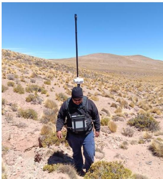
Figura 24: Método de magnetometría terrestre en el campo donde un solo operario en el terreno es suficiente para llevar adelante esta tarea.
