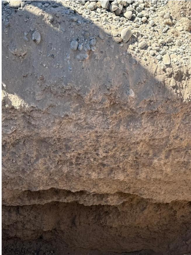
Figura 4: Depósitos de conglomerados cementados con material carbonático en el sitio de la cantera.
