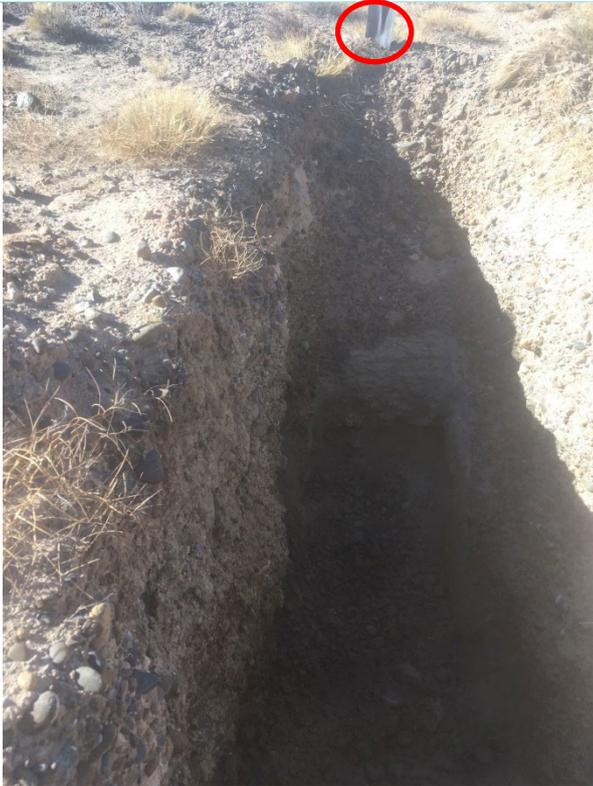
**Foto 3** Vista del subsuelo en donde se evidencia la capa de rodados patagónicos y el contacto con arcillas blanquecinas a unos 1,8 m aprox. La elipse roja muestra la pala como escala.  $45^{\circ}19'39,16''S - 67^{\circ}42'8,21''O$
