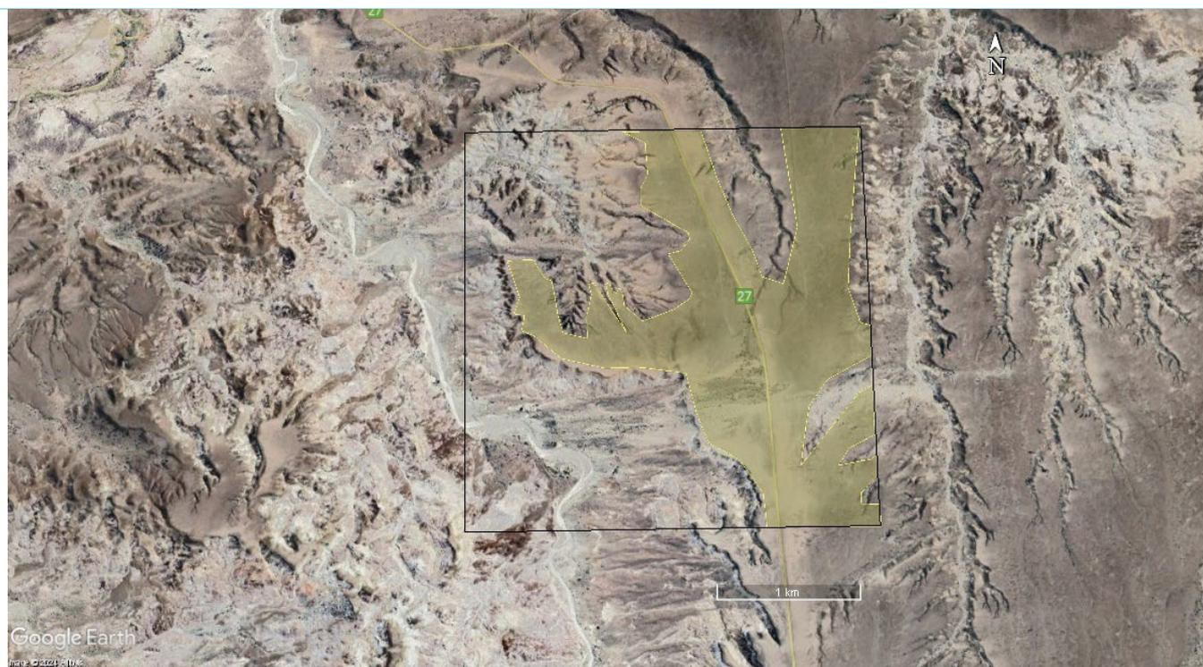
**Imagen 1:** 45°20'8,97"S – 67°42'59,86"O Coord. Central. Vista en planta de la propiedad minera en el rectángulo negro. El polígono amarillo corresponde a los sectores planos de rodados patagónicos debajo de los cuales se aloja el material potencial a explotar. Se distingue la traza N-S de la ruta provincial N°27 en el sector central desde la que se pueden realizar los accesos a la cantera una vez que se decida su ubicación final.
