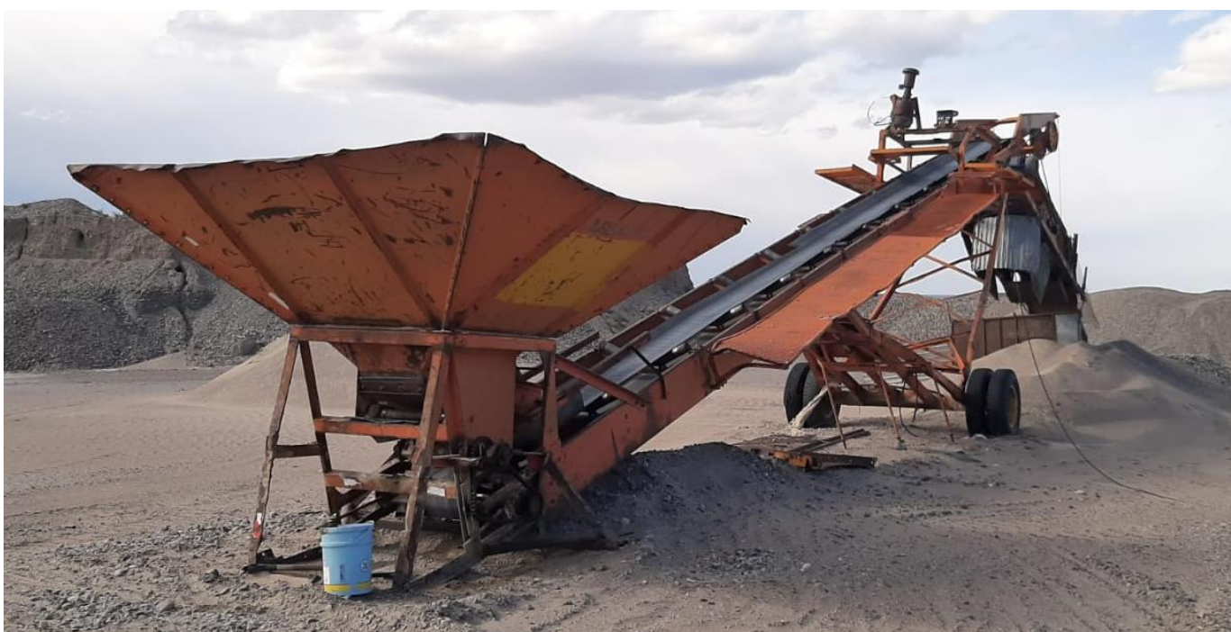
ZARANDA PARA LA SEPARACION DE LA ARENA.
