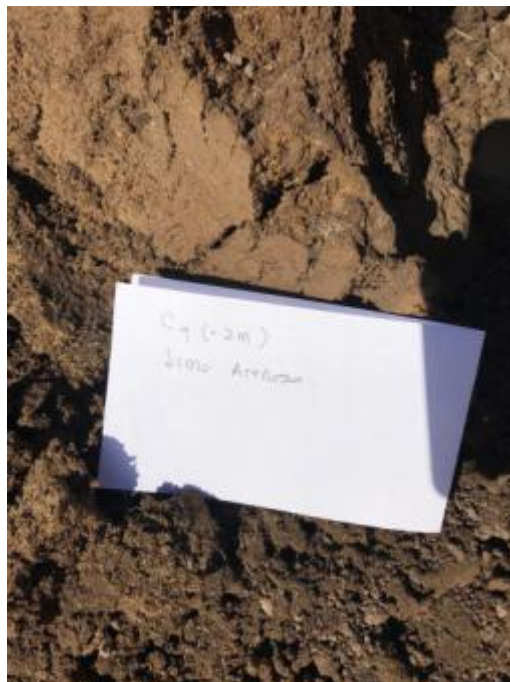
Imagen N°11: Perforación 9. Profundidad -1,00 m. Suelo Orgánico
