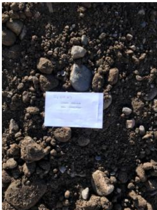
Imagen N°6: Perforación 7. Profundidad -1,00 m. Grava Mediana
