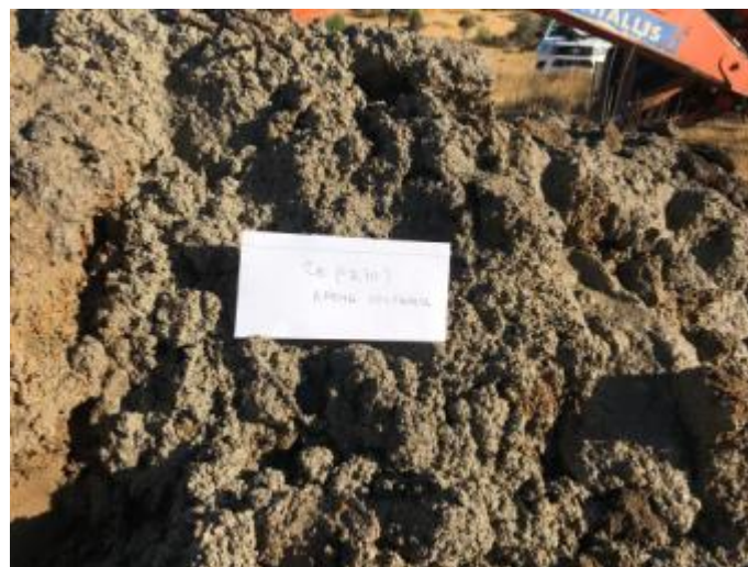
Imagen N°9: Perforación 8. Profundidad -2,20 m. Arena Limosa
