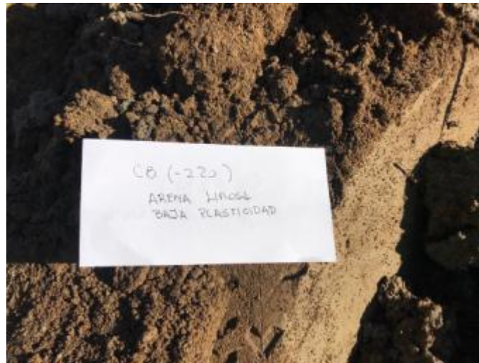
Imagen N°9: Perforación 8. Profundidad -2,20 m. Arena Limosa
