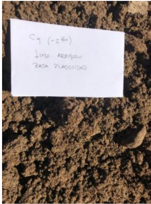
Imagen N°13: Perforación 9. Profundidad -2,80 m. Limo Arenoso
