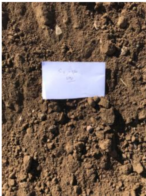
Imagen N°4: Perforación 6. Profundidad -1,50 m. Limo
