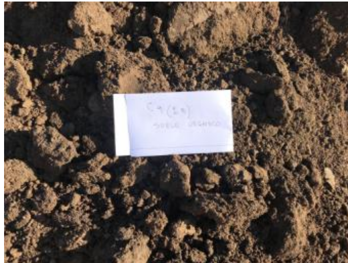
Imagen N°11: Perforación 9. Profundidad -1,00 m. Suelo Orgánico
