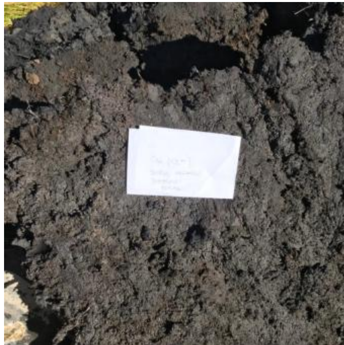
Imagen N°14: Perforación 10. Profundidad -2,00 m. Suelo Orgánico
