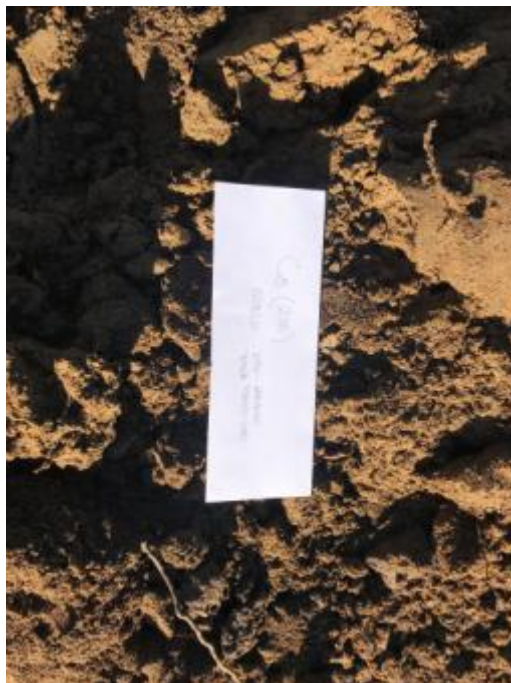
Imagen N°8: Perforación 8. Profundidad -2,00 m. Limo Arenoso
