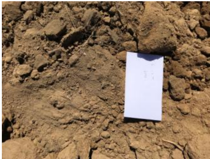
Imagen N°3: Perforación 6. Profundidad -2,00 m. Limo
