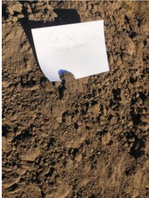
Imagen N°7: Perforación 8. Profundidad -1,00 m. Suelo Orgánico
