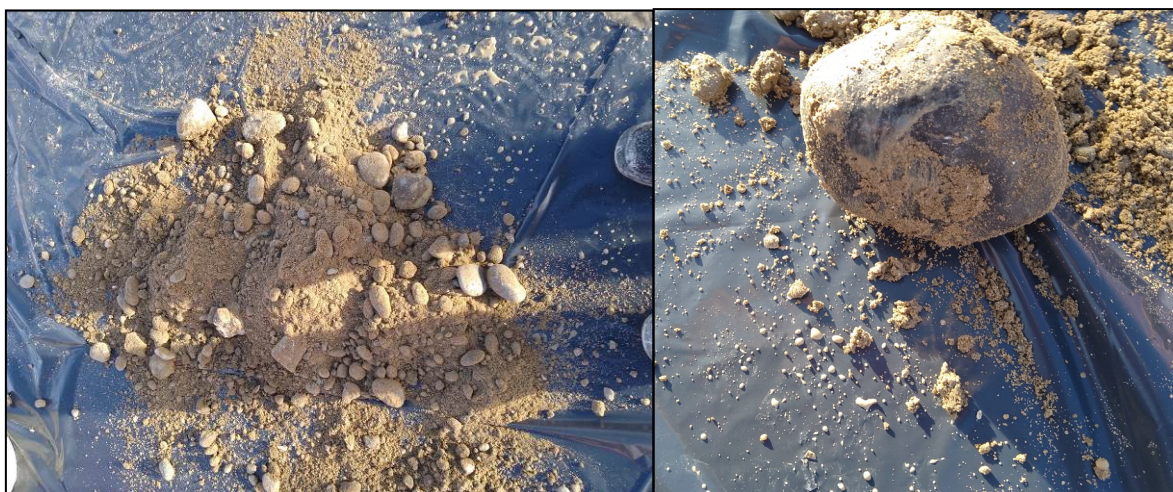
Fotografía 9: Sedimentos atravesados correspondientes a depósitos cuaternarios aluvionales del Río Chubut. Algunos rodados flotando en una matriz que va de granulometría limo arenosa a grava.
